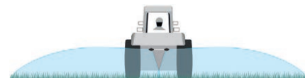
Utilizzo degli ugelli per trattamenti senza barra Use of nozzles for boomless spraying Utilizo de las boquillas para tratamientos sin barra.
